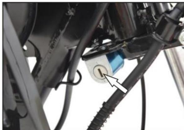
Para bloquear la cabecera del vehículo, primero gire el volante hacia la izquierda hasta que alcance el punto límite, luego inserte la llave en el orificio de bloqueo y gírela en el sentido de las agujas del reloj hasta el final para bloquearlo.
