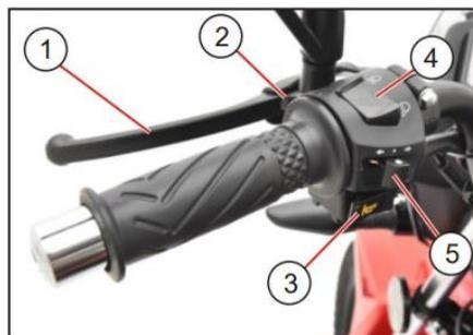
Mango de embrague: Al arrancar el motor, frenar o cambiar, sostenga firmemente la manija para separar la placa de fricción del embrague y cortar el sistema de transmisión.
