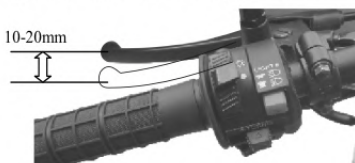
Tuerca de Ajuste Tuerca de Bloqueo Espacio de la Palanca de Embrague 10-20mm
