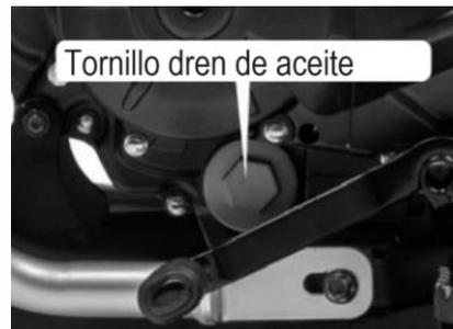
Retire el tornillo dren (4) de la parte inferior del motor caliente para drenar todo el aceite caliente.
