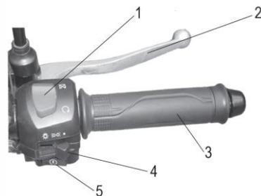
1. Cortacorriente    2. Palanca de freno    3. Acelerador    4. Interruptor de luces    5. Arranque
