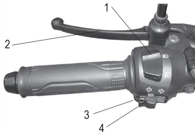
1. Interruptor luces altas   2. Palanca de embrague   3. Interruptor de claxon   4. Interruptor de direccionales
