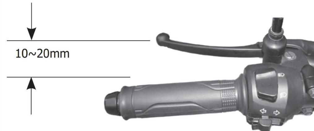
**\* El embrague debe ajustarse con el motor apagado.**
