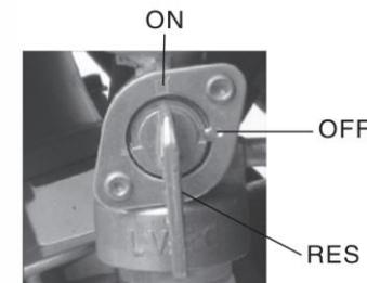
Esta motocicleta está equipada con una válvula de combustible operada manualmente. Hay tres posiciones: "ON", "OFF" y "RES"
