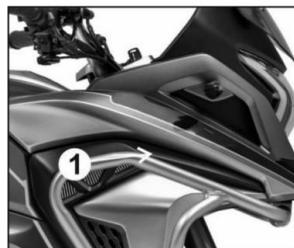
3. Placa de identificación: La placa de identificación se fija en el tubo vertical derecho del cuadro, ahí podrás encontrar información relevante del vehículo.
