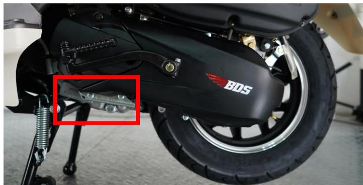
3. Placa de identificación: La placa de identificación se fija en el tubo vertical derecho del cuadro, ahí podrás encontrar información relevante del vehículo.
