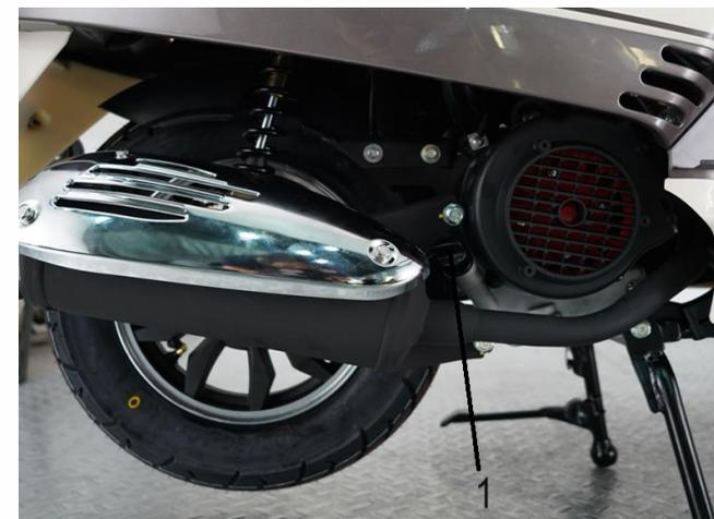
El nivel de aceite debe quedar entre las líneas superior e inferior del indicador de aceite, que está atornillado al orificio de llenado.
