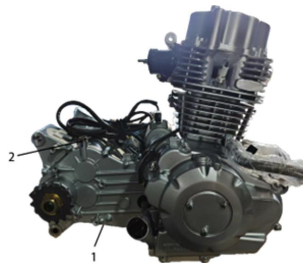
1. Tapón de drenaje de aceite de caja de cambios (17 mm) 2. Tapón de llenado de aceite de la caja de cambios (17 mm)
