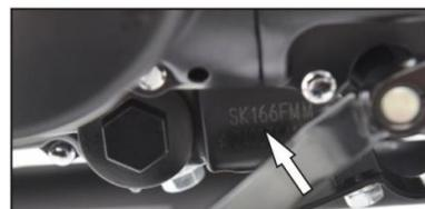
Placa de metal: La placa de metal se fija en el tubo vertical derecho del marco.
