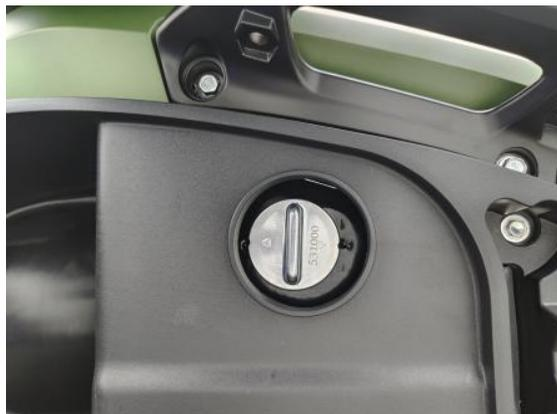
El volumen del tanque de combustible es de **7.5 L**. Se recomienda gasolina con un octanaje superior a **90**. Esto con el fin de alargar la vida útil del motor.
