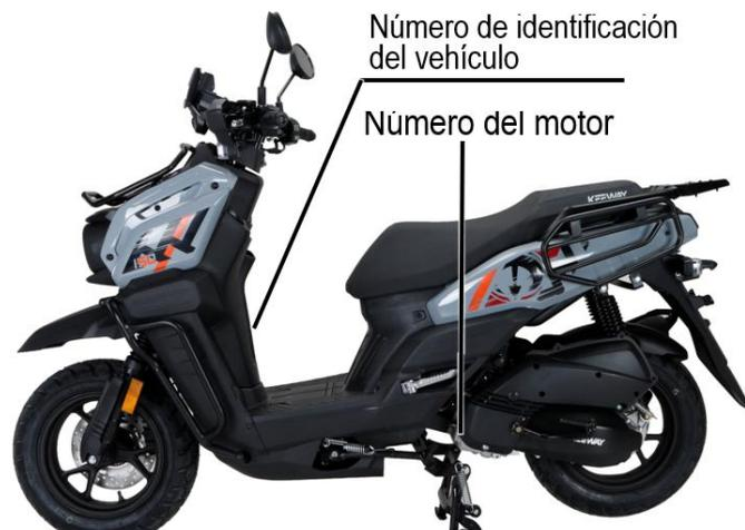
3. Placa de identificación: La placa de identificación se fija en el tubo vertical derecho del cuadro, ahí podrás encontrar información relevante del vehículo.
