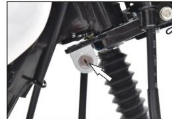
Para bloquear la cabeza del vehículo, primero gire el volante hacia la izquierda hasta llegar al punto límite, luego inserte la llave en el orificio de bloqueo y gírela en el sentido de las agujas del reloj hasta el final para bloquearlo.
