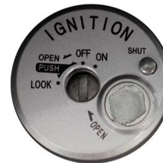
1. Coloque la llave en la ranura para poder cambiar la posición del interruptor
