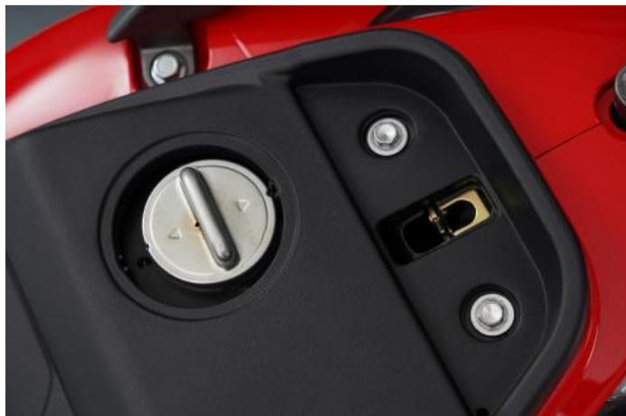
El volumen del tanque de combustible es de **6.6 L**. Se recomienda gasolina con un octanaje superior a **92**. Esto con el fin de alargar la vida útil del motor.
