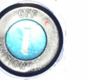
1. IGNITION (ENCENDIDO): El motor y las luces se pueden operar y la llave no se puede quitar.
